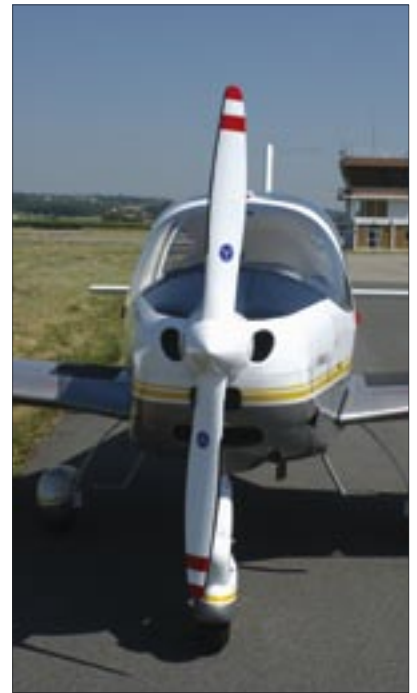
Le P2002 a une silhouette longiligne, très esthétique. Haut sur pattes, l'accès à bord se fait par un marchepied avant. Le train tricyle, efficacement carréné, permet l'école de début. L'hélice bipale Hoffmann en bois est entraînée par un classique Rotax 912 S à refroidissement air et eau. Le manche ergonomique actionne micro et trim de profondeur. Ô surprise : une manette de friction permet de régler la dureté de manette des gaz...
