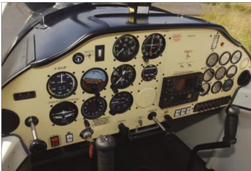
Planche VSV et équipements plus que suffisants pour l'école et le petit voyage. Le Garmin 430 (COM/NAV/GPS), optionnel, est un luxe nécessaire. L'environnement est immédiatement familier.
